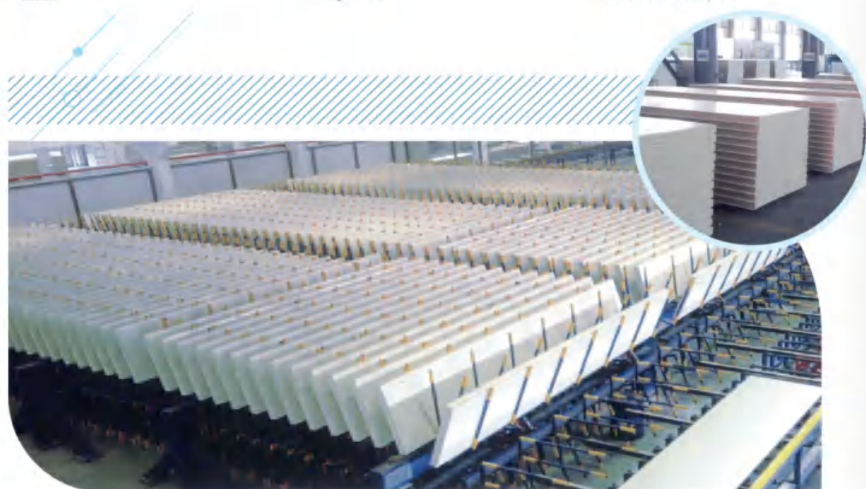
▲ 凉板系统 Panel cooling system
